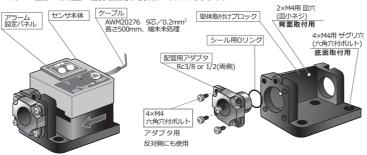
注) 単体取付けブロックは、取付け寸法により底面を固定(4個のM4六角穴付ボルト使用) 背面を固定 (2個のM4 皿小ネジ使用) 或いは、パイプによる固定などが可能です。
