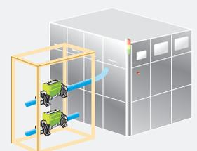
設定水量に満たない時は、警報を出力し、装置の過熱を防ぎます。アナログ出力で流量表示することも可能です。
