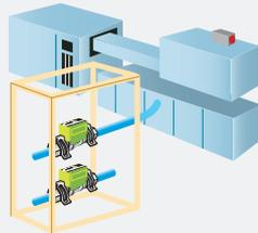
流体の温度は0~90℃の冷水水に対応しています。設定水量に満たない時は、警報を出力し、装置の過熱を防ぎます。
