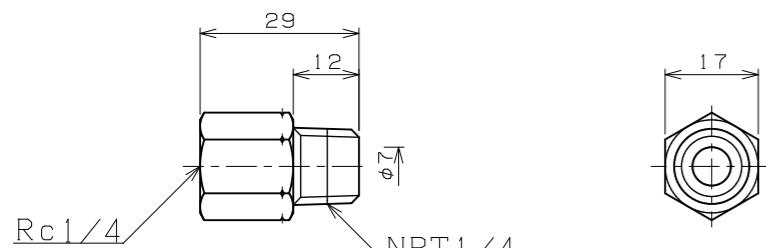
NPTネジ側にノッチ加工。
