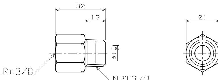
NPTネジ側にノッチ加工。
