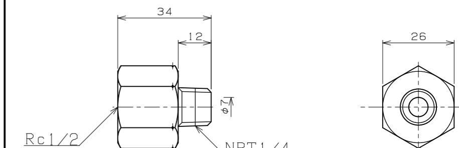
NPTネジ側にノッチ加工。
