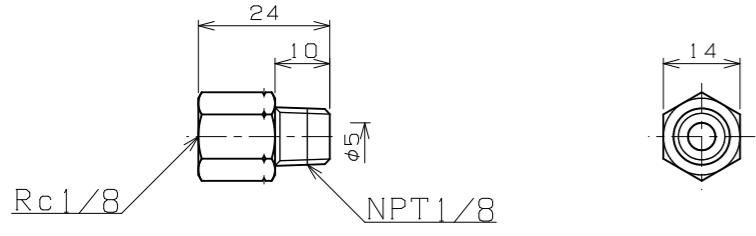
NPTネジ側にノッチ加工。
