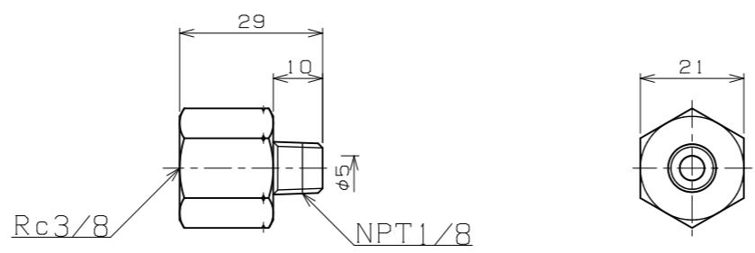
NPTネジ側にノッチ加工。
