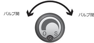
② ストッパーを時計回りに回してノブを固定します。人的な誤接触や、流れの圧力によって開度が変わってしまうことを防ぎます。
