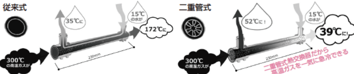
二重管式と従来式の熱交換器(長さ:約230mm)に300℃の高温ガス(20NL/min)、と15℃の水(40mL/min)を流した時の熱交換温度の比較
