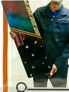
装の技術も開発した。産業機械などの筐体と同塗装を施すだけで、温度変化が目視できるようになる。高温になると色が変化する特殊塗料は、一般的にも市販されているが、それを防錆性などに優れた工業用塗装にする技術はなかったという。今回製作したサンプル品は、22度から45度になると黒から白に変化する。今後は同じく用途開拓を図っていく。
