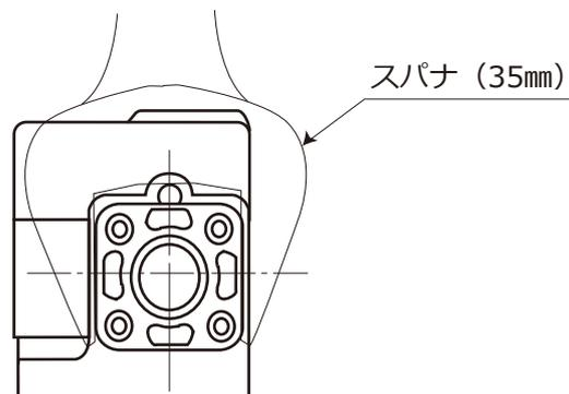
3. 配管用アダプターの内径は、Rc3/8ネジor Rc1/2ネジ になっています。
